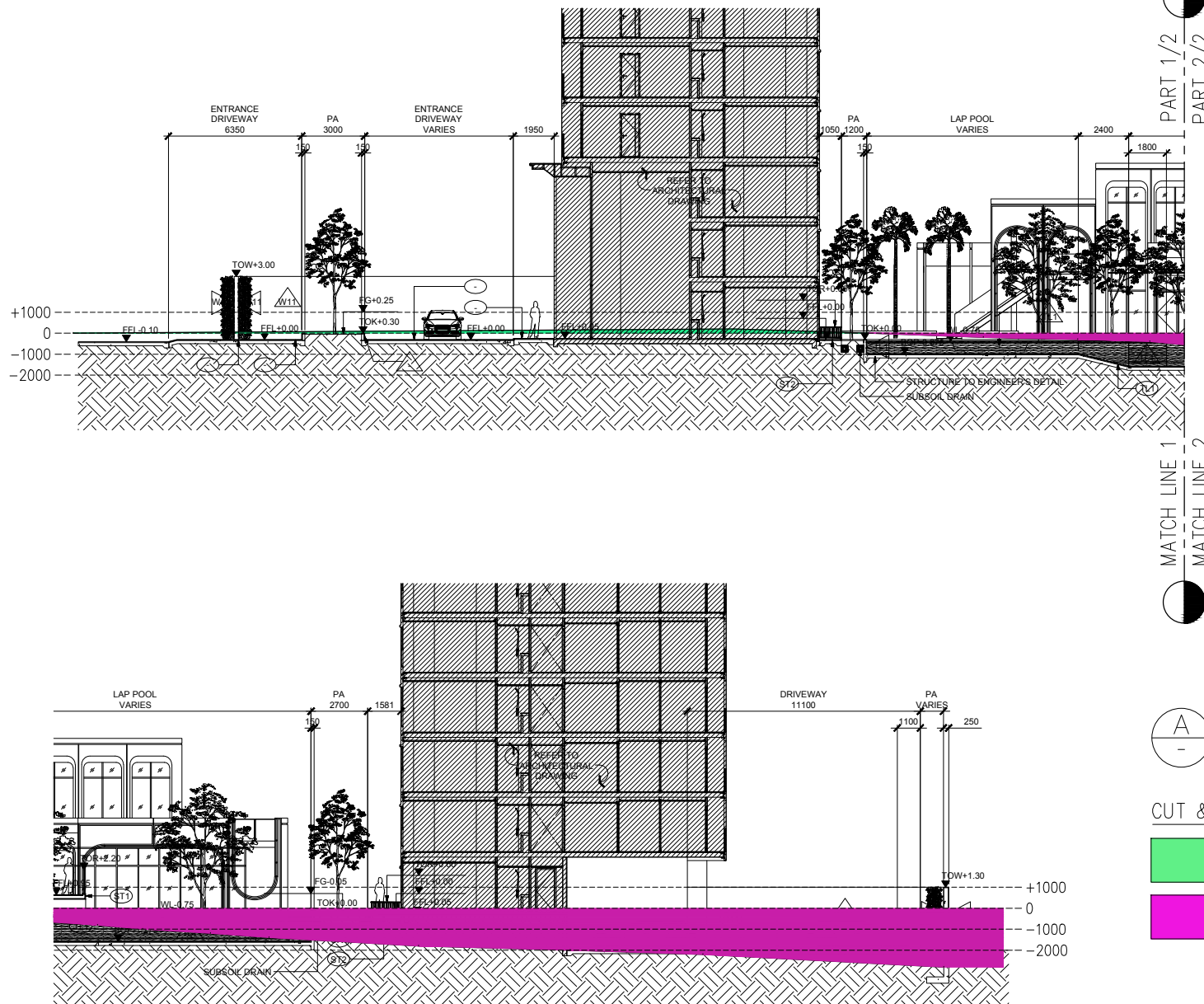
รูปที่ 2.13.3-3 ภาพตัดดินขุดดินถม (แนวตัด A)
